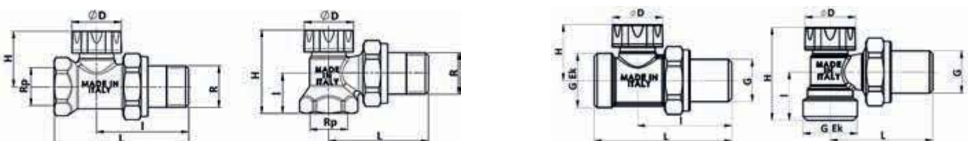
Рис. 31. Устройство запорно-балансировочного клапана типа SVL
