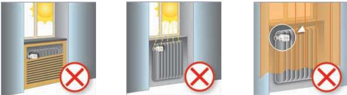
Рис. 8. Требования по размещению автоматического терморегулятора
