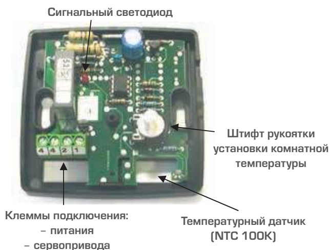
Рис. 12. Устройство электронного термостата для напольного отопления
