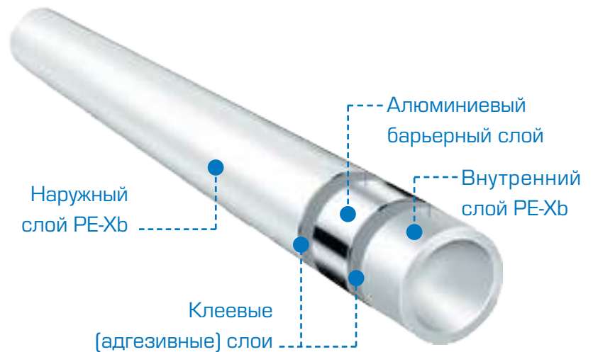
Рис. 5. Пятислойная металлополимерная труба PE-Xb/Al/PE-Xb
