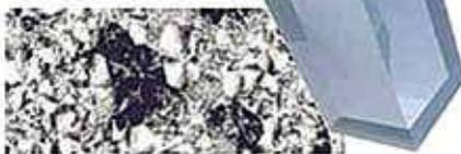
Для изготовления трубных систем высокотемпературного отопления (до 95 °C), компания PIPELIFE использует материал PP-RCT (Beta PPR) – рандомный сополимер полипропилена с особой кристаллической структурой, обеспечивает максимальную эффективность, при предельных нагрузках (серый). Данный материал имеет BETA структуру, молекулярная сетка выглядит так:
