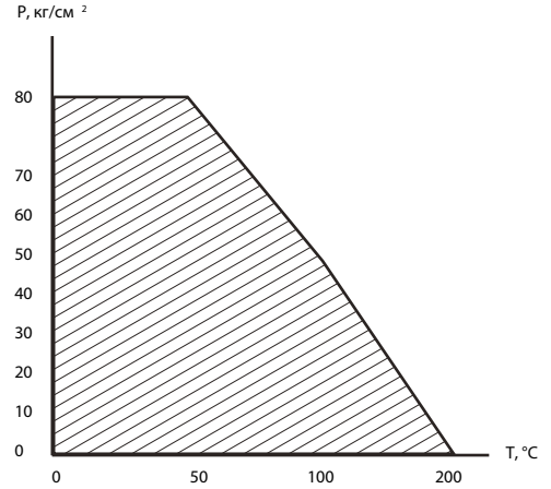
График рабочего поля вода-пар
