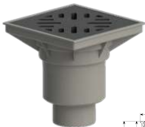
ТП-606 Трап дворовый с мусоросборником, с запахозапирающим устройством с вертикальным выпуском 160/110 мм
