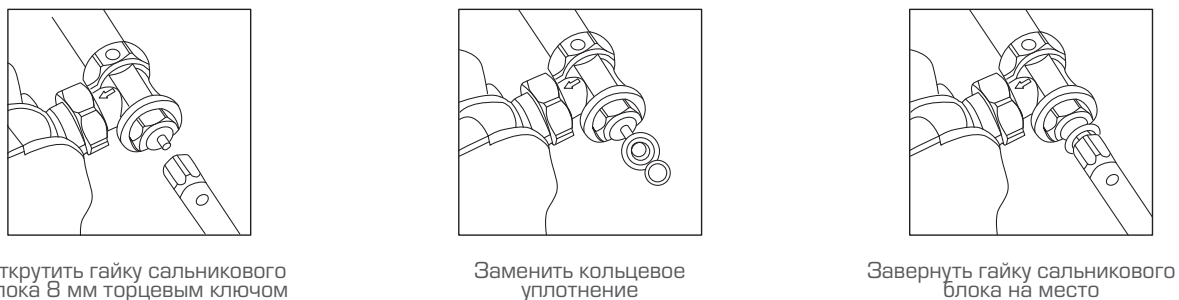
Рис. 21. Замена кольцевого уплотнения штока клапана терморегулятора
