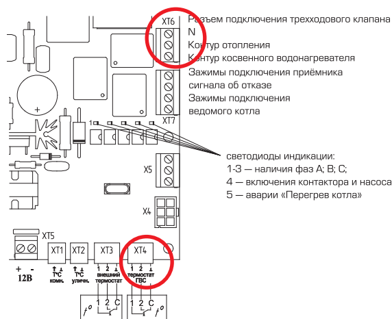
Рис. 13. Схема подключения датчика температуры бойлера
