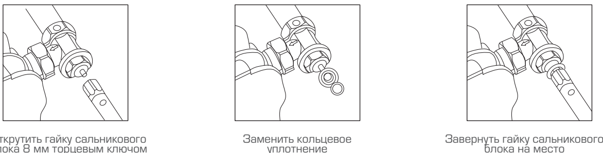
Рис. 21. Замена кольцевого уплотнения штока клапана терморегулятора
