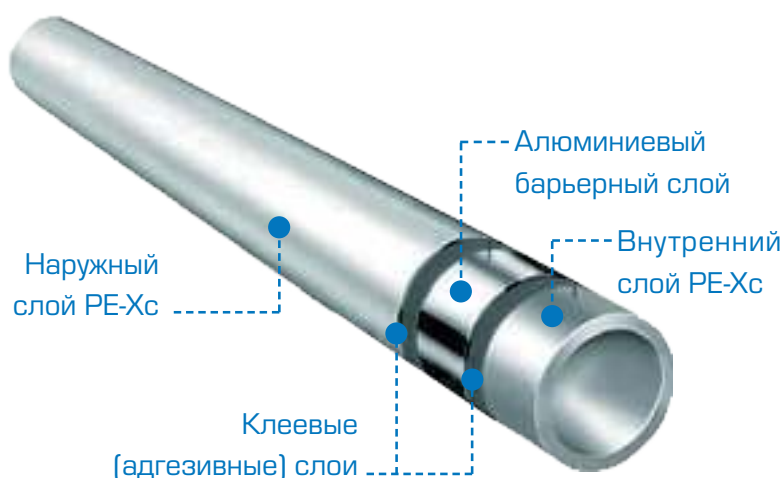
Рис. 2. Пятислойная труба PE-Xc/Al/PE-Xc
