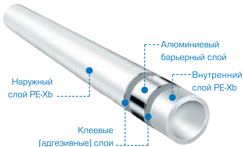
Рис. 5. Пятислойная металлополимерная труба PE-Xb/Al/PE-Xb
