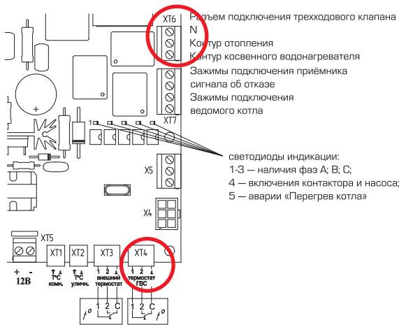
Рис. 13. Схема подключения датчика температуры бойлера
