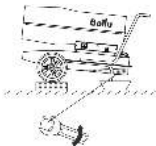
рис. 8 Опорожнение топливного бака для ВНДР-30, ВНДР-50
