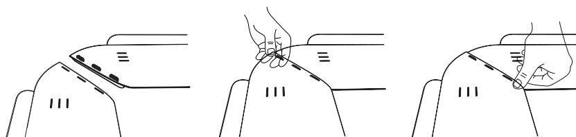
Вставьте крайний фиксатор ребра в крайнее отверстие крыла. Прощёлкните до упора оставшиеся фиксаторы в оставшиеся отверстия крыла.
