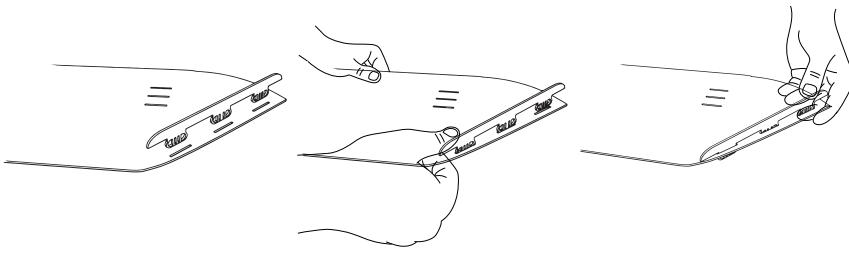
Аналогично закрепите второе ребро на другом конце этого крыла. Вставьте два оставшихся ребра во второе крыло таким же образом.
