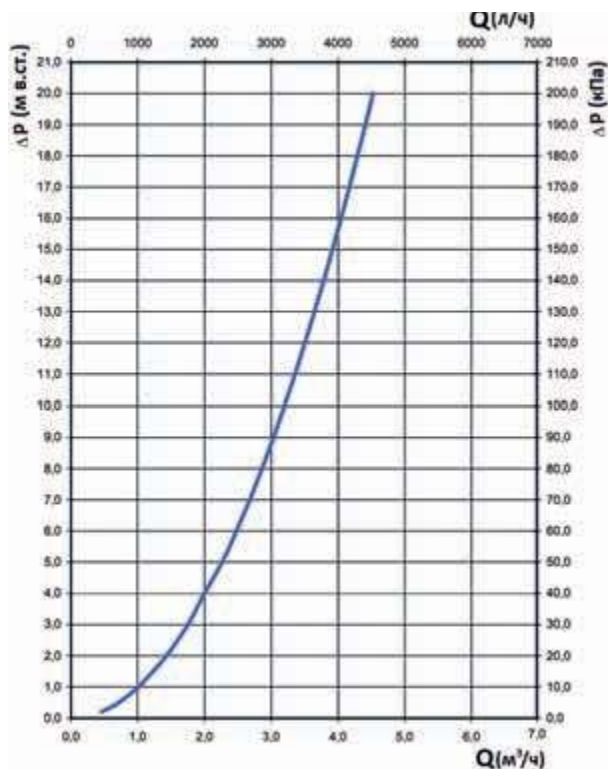
Рис. 29. Потери напора у групп с 3-х ходовым термостатическим клапаном для твердотопливных котлов
