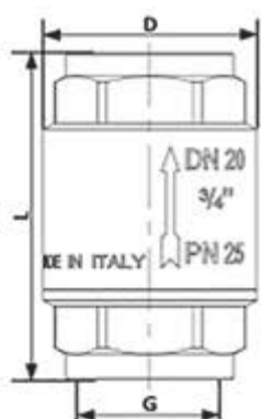
Рис. 32 Габаритные и присоединительные размеры обратного клапана с пластиковым затвором
