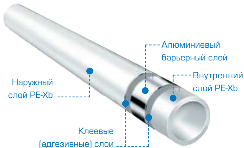
Рис. 5. Пятислойная металлополимерная труба PE-Xb/Al/PE-Xb
