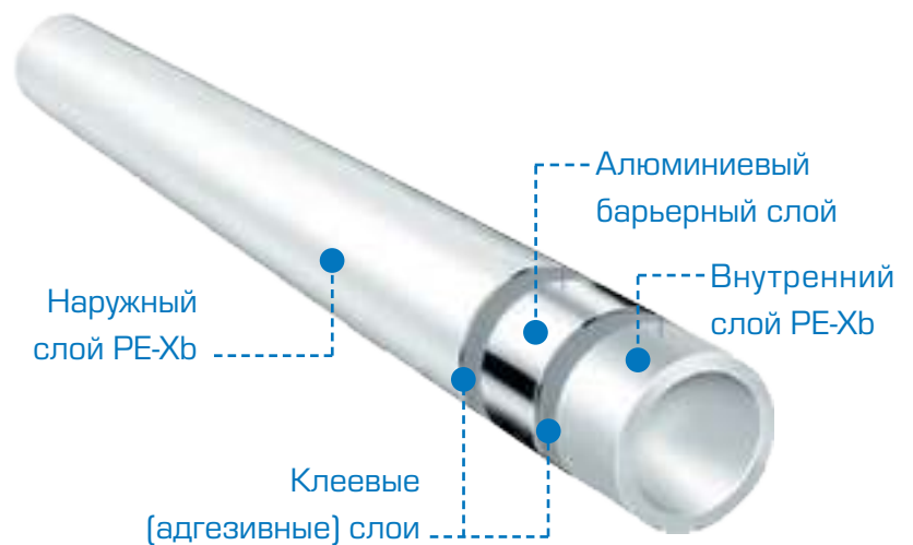
Рис. 5. Пятислойная металлополимерная труба PE-Xb/Al/PE-Xb
