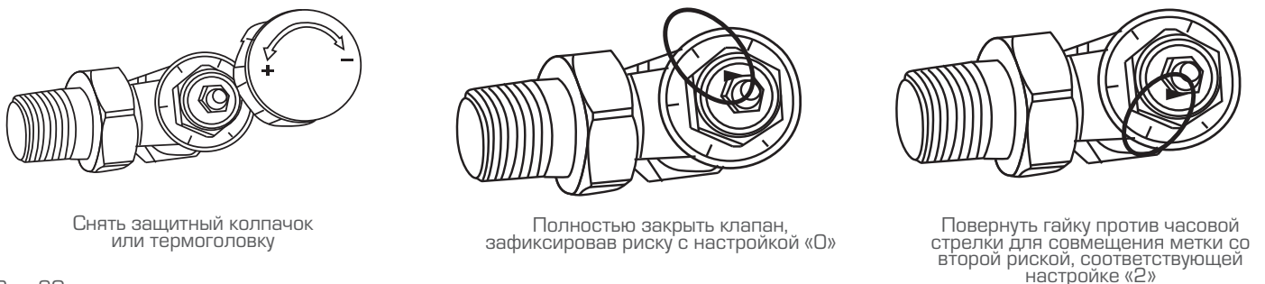
Рис. 20. Пример преднастройки клапана терморегулятора
