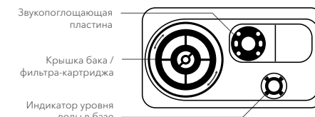
Рис. 2b Устройство бака прибора
