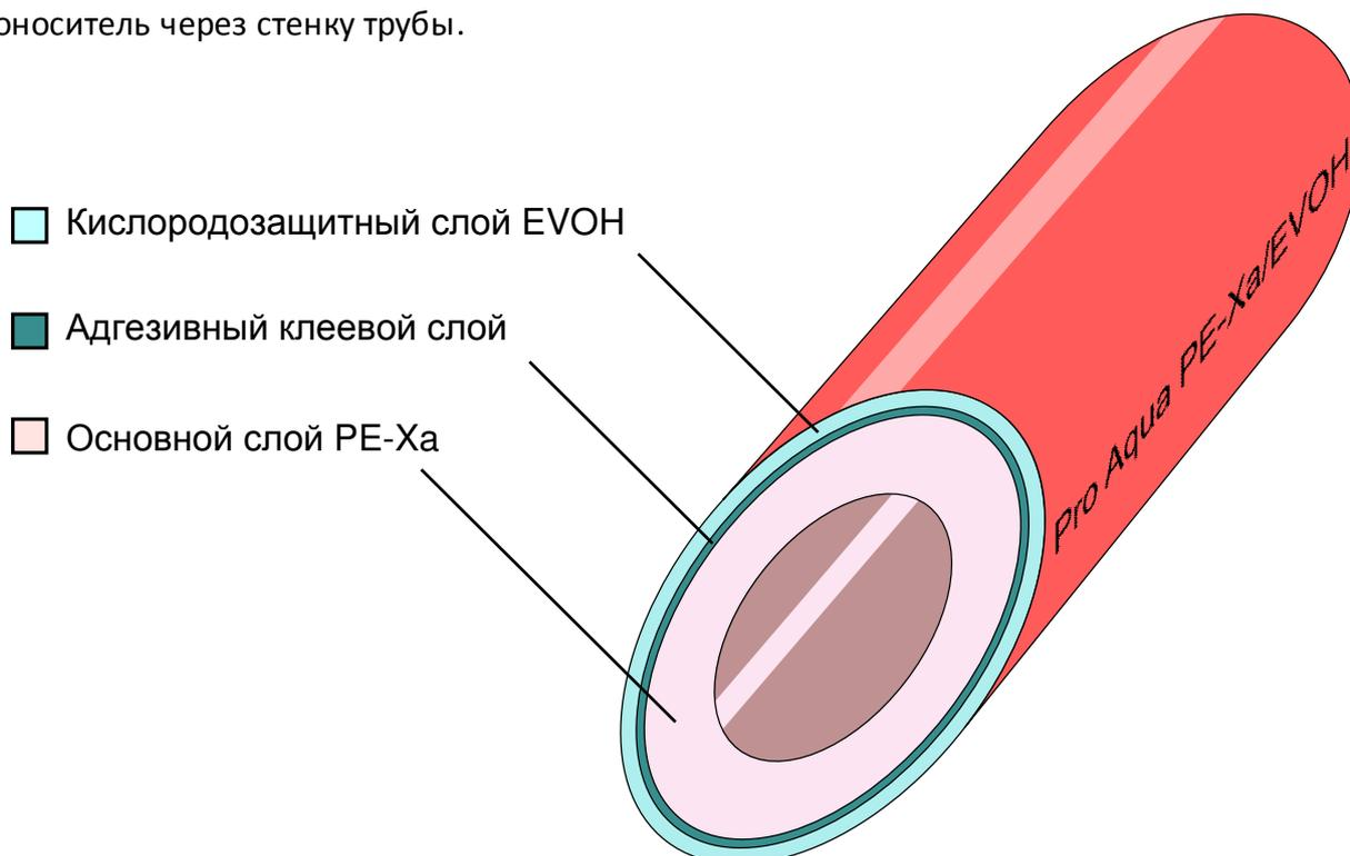
1.3 Труба напорная Pro Aqua из сшитого полиэтилена (PE-Xa) с кислородозащитным слоем EVOH S3,5 / S4,5 производится в красном цвете.
