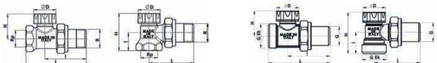
Рис. 31. Устройство запорно-балансировочного клапана типа SVL
