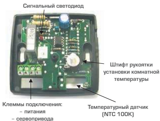
Рис. 12. Устройство электронного термостата для напольного отопления
