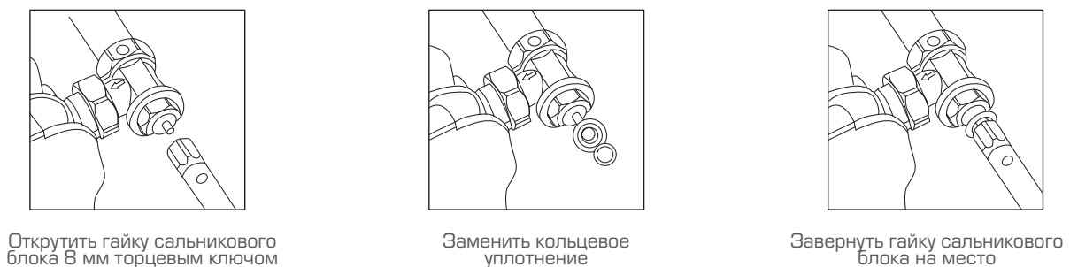
Рис. 21. Замена кольцевого уплотнения штока клапана терморегулятора
