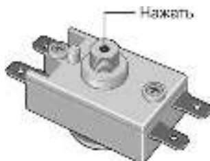
Рисунок 3. Расположение штока на термовыключателе.
