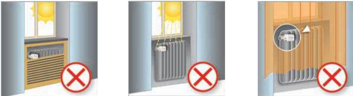
Рис. 8. Требования по размещению автоматического терморегулятора
