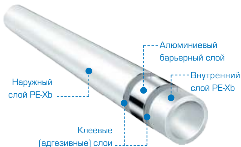
Рис. 5. Пятислойная металлополимерная труба PE-Xb/Al/PE-Xb
