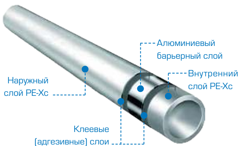
Рис. 2. Пятислойная труба PE-Xc/Al/PE-Xc
