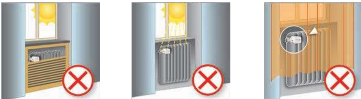
Рис. 8. Требования по размещению автоматического терморегулятора
