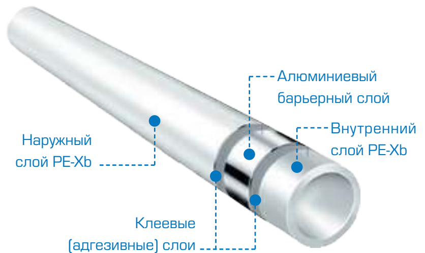
Рис. 5. Пятислойная металлополимерная труба PE-Xb/Al/PE-Xb
