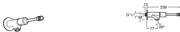
Instant Care 5A7977C00 CARE - Монтируемый на стену кран для раковины. С аэратором.
