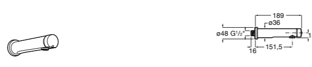
Avant 5A7979C00 Кран для раковины, встраиваемый в стену, с длинным изливом, 190 мм. С аэратором.
