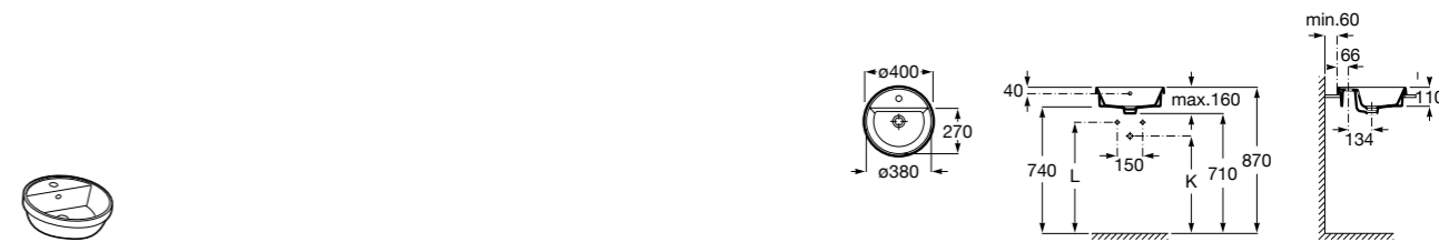
The Gap Round 3270Y4000 Раковина керамическая врезная. Смеситель не входит в комплект.
