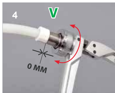
4 Расширение трубы (2). Шаг за шагом, проворачивая инструмент, перемещать далее трубу по расширительной насадке до упора. Поворот инструмента обязателен для равномерного расширения - правильного монтажа.
