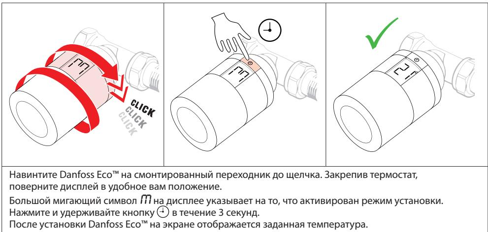
Навинтите Danfoss Eco™ на смонтированный переходник до щелчка. Закрепив термостат, поверните дисплей в удобное вам положение.
