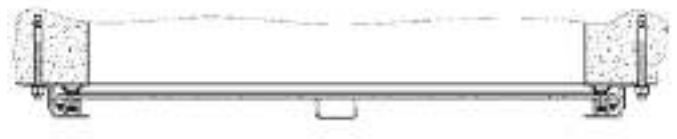
Установка в существующем канале (тип FM)
