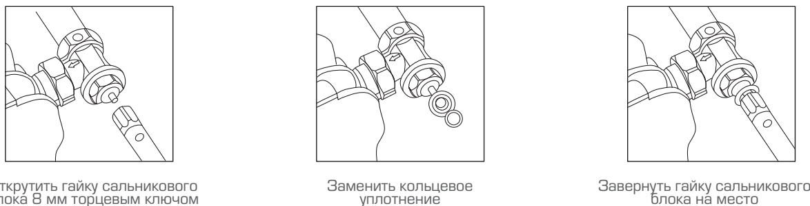
Рис. 21. Замена кольцевого уплотнения штока клапана терморегулятора
