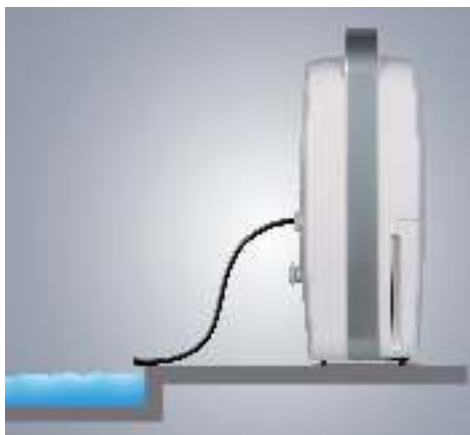
Рис. 2 Правильная установка и расположение шланга для отвода конденсата.
