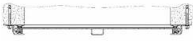
Установка в существующем канале (тип FM)
