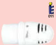
011 | <b>Терmostатическая головка ГЕРЦ-Design-MINI „D“,</b><br>с жидкостным датчиком (гидросенсором), диапазон регулирования 8–28 °C, автоматическая морозозащита при прибл. 8 °C.<br>Размеры: длина 88 мм, диаметр маховика 45 мм.<br>Предназначается только для радиаторов с встроенным клапаном (например, Vogel & Noot, модельный ряд с индексом KV).                          | 1 9200 99    | 20 |
