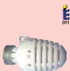
011   | <b>Терmostатическая головка ГЕРЦ-Design "D"</b><br>с жидкостным датчиком (гидросенсором), с позициями теплового запирания "0" и морозозащиты при прибл. 6°C. Ограничение и блокировка диапазона регулирования 0–30°C с помощью ограничительных штифтов 1 9551 00 (заказываются отдельно).<br>Дизайн разработан совместно с "Porsche Design GmbH". | 1 9230 99    | 20 |
