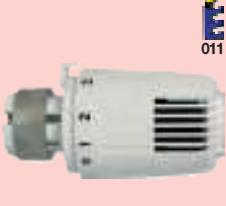
011   | <b>Терmostатическая головка ГЕРЦ-Design "D"</b><br>с жидкостным датчиком (гидросенсором), позиция морозозащиты при прибл. 6°C. Ограничение и блокировка диапазона регулирования 6–28°C с помощью ограничительных штифтов 1 9551 00 (заказываются отдельно).<br>Дизайн разработан совместно с "Porsche Design GmbH".                               | 1 9260 99    | 20 |
