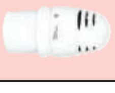
011 | <b>Терmostатическая головка ГЕРЦ-Design-MINI „D“,</b><br>с жидкостным датчиком (гидросенсором), диапазон регулирования 0–30 °C, позиция теплового запирания «0», позиция морозозащиты при прибл. 8 °C.<br>Размеры: длина 88 мм, диаметр маховика 45 мм.<br>Предназначается только для радиаторов с встроенным клапаном (например, Vogel & Noot, модельный ряд с индексом KV) | 1 9200 09    | 20 |
