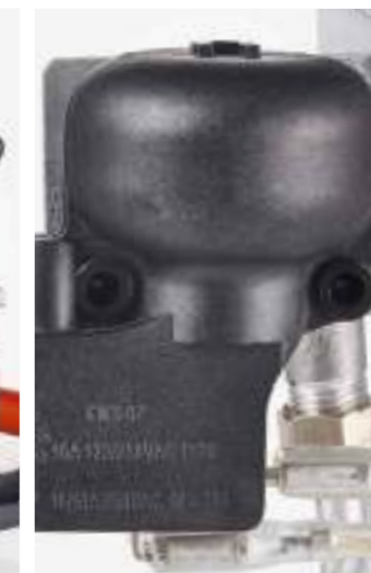
Датчик опрокидывания прибора
