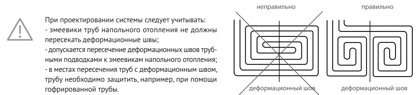
Рисунок 44. Пересечение деформационного шва
