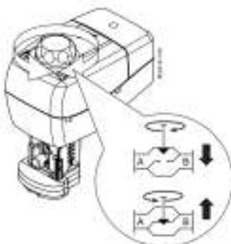
Ручное позиционирование производится вращением рукоятки на крышке привода. Для выполнения позиционирования следует:
