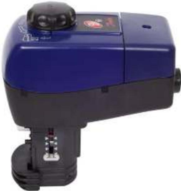
Приводы электрические типа АМЕ модификация 435 QM (далее – АМЕ 435 QM) предназначены для работы с клапанами балансировочными типа АВ-QM с условным проходом от 40 до 100 мм, управляющими подачей тепло- и холodoносителя в фэнкойлы или небольшие вентиляционные установки.
