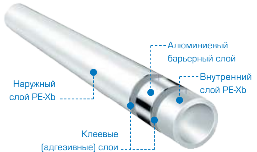
Рис. 5. Пятислойная металлополимерная труба PE-Xb/Al/PE-Xb
