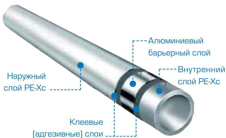
Рис. 2. Пятислойная труба PE-Xc/Al/PE-Xc
