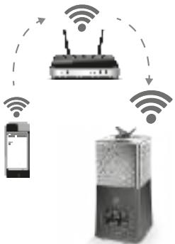
5. Приложение запросит в диалоговом окне выбрать имя Wi-Fi сети (SSID), а также ввести пароль и местоположение устройства. Тип устройства будет определен автоматически. При установленном соединении с сервером индикатор беспроводной сети на дисплее увлажнителя горит, не мигая.
