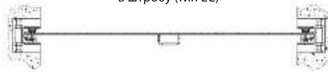
Установка бетонированием в штробу (тип ЕС)
