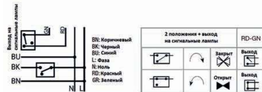
Рис. 22. Схемы электрических соединений привода для зонального клапана с шаровым затвором
