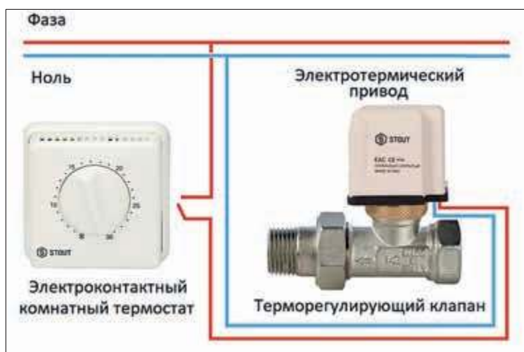
Рис. 3. Схема электрических соединений сети управления
