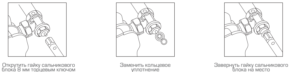
Рис. 21. Замена кольцевого уплотнения штока клапана терморегулятора
