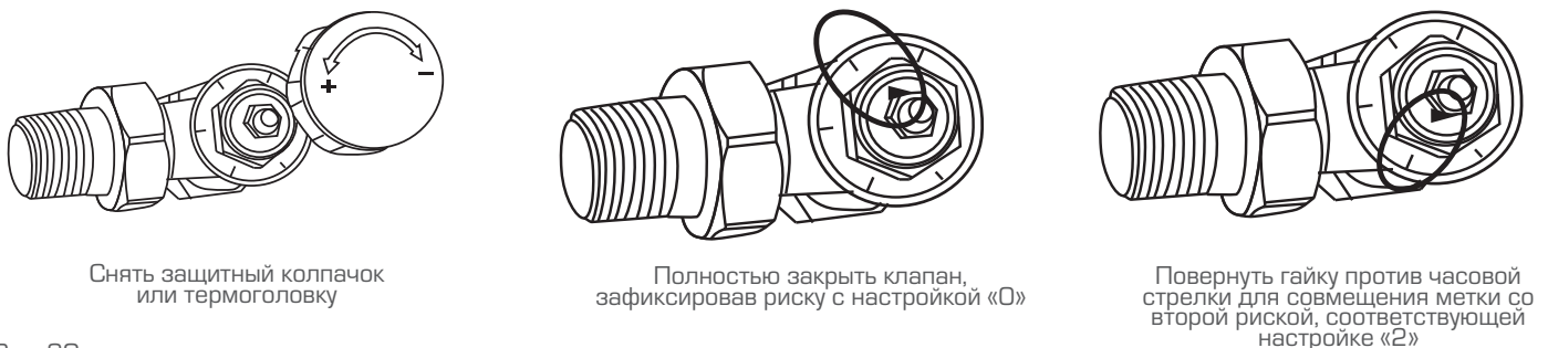
Рис. 20. Пример преднастройки клапана терморегулятора
