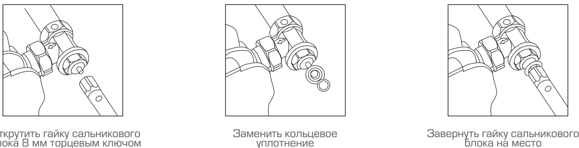
Рис. 21. Замена кольцевого уплотнения штока клапана терморегулятора
